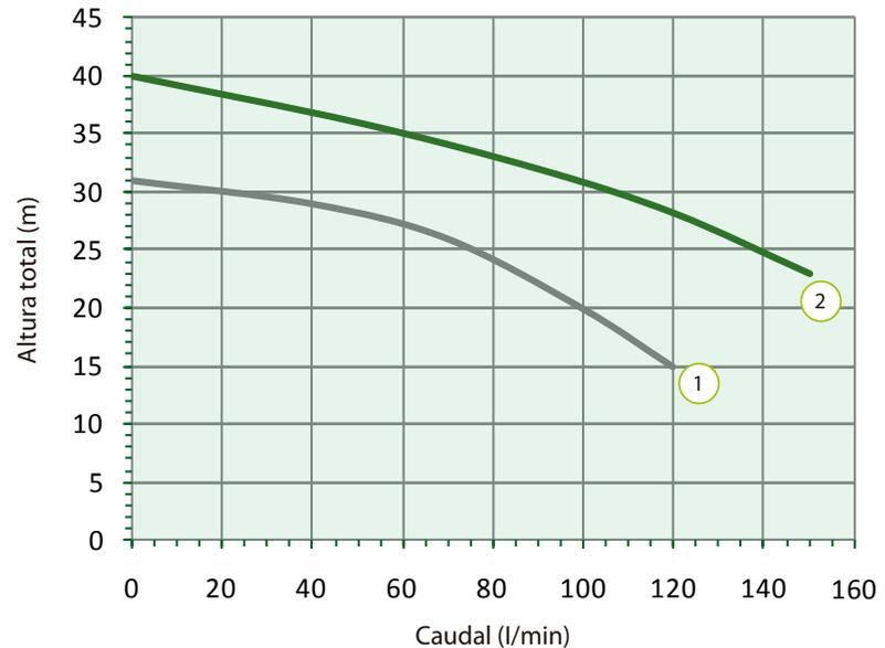
Bomba centrífuga de un rodete; caudal medio y presión moderada. Adecuada para bombear agua limpia y no agresiva, cargada con pequeñas impurezas sólidas. Utilizada en riego de jardines y sistemas de presión domésticos, así como en instalaciones industriales.
