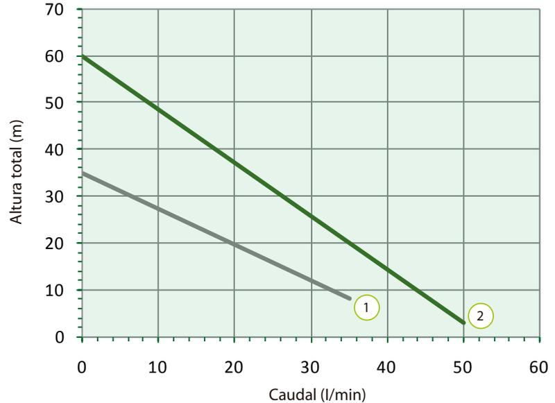
Bomba con impulsor periférico de alta presión y bajo caudal. Adecuada para bombear agua limpia y no agresiva. Utilizada en sistemas domésticos de presurización, riegos de huertos y jardines.
