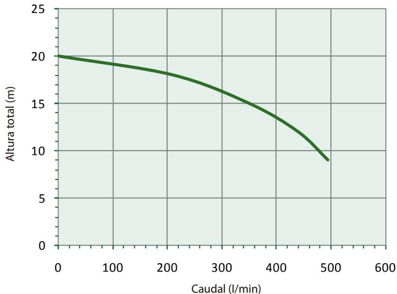
Bomba centrífuga de un rodete de gran caudal y altura de elevación moderada. Adecuada para bombear agua limpia y no agresiva, cargada con pequeñas impurezas sólidas. Utilizada en agricultura y en instalaciones industriales de acondicionamiento o de refrigeración.
